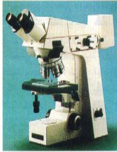
ميكروسكوب حديث ذو عدستين عينية . ويلاحظ وجود برج دوار يسمح باختيار العدسات الشبكية المناسبة .
