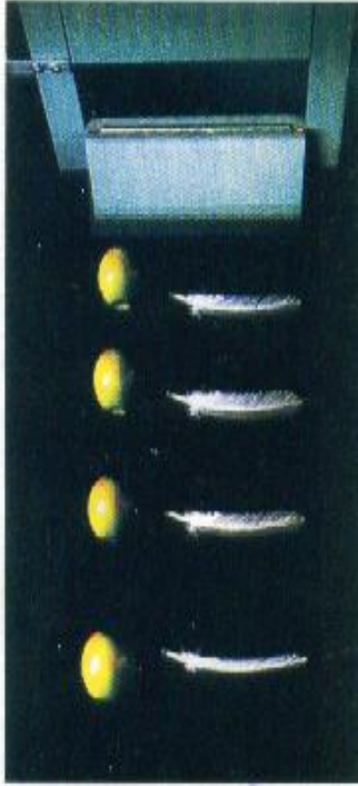
سقوط تفاحة وريشة في غرفة مفرغة . عند إهمال مقاومة الهواء تسقط جميع الأجسام بنفس العجلة
