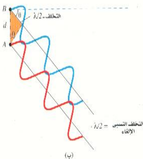
شكل 4-24: تحدث التقوية عند الزوايا التي يكون التخلف فيها مساوياً \lambda ، 2\lambda ، 3\lambda . إلخ . أما الإلغاء فيحدث عندما يكون التخلف النسبي هو \lambda/2 ، 3\lambda/2 ، 5\lambda/2 ، إلخ . .
